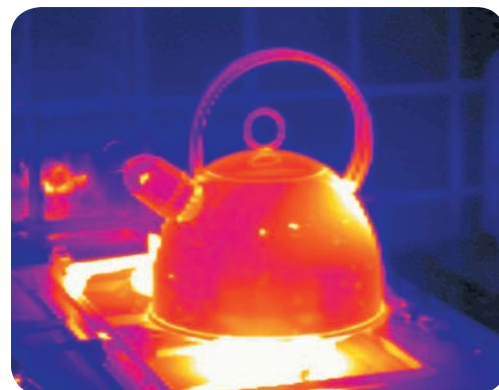
Termografia de uma chaleira sobre o fogo.
