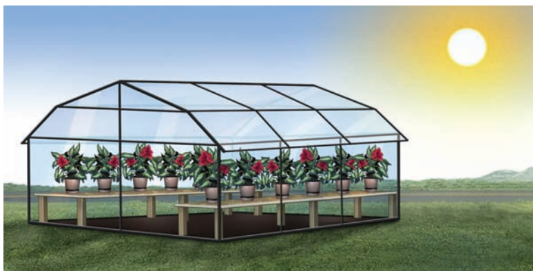
Figura 12. Estufa: o vidro é transparente à energia radiante incidente e opaco às ondas de calor reemitidas.
