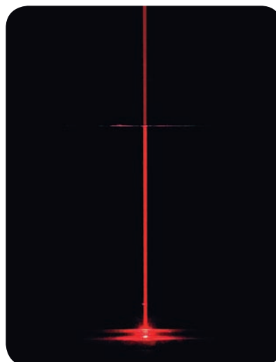
► Incidência normal: a refração ocorre sem desvio.
