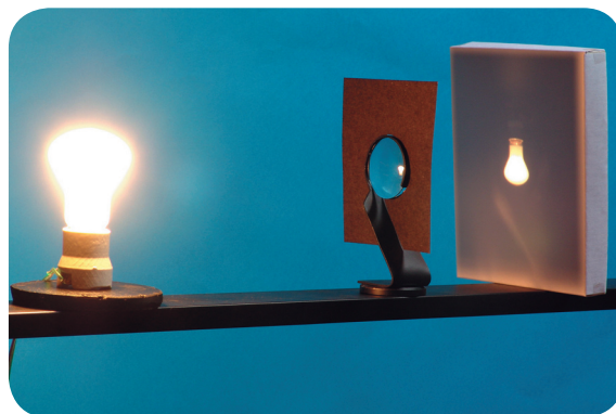
O objeto real (a lâmpada) está situado além do ponto antiprincipal objeto C . A imagem é real (projetada no anteparo), invertida e menor que o objeto.
