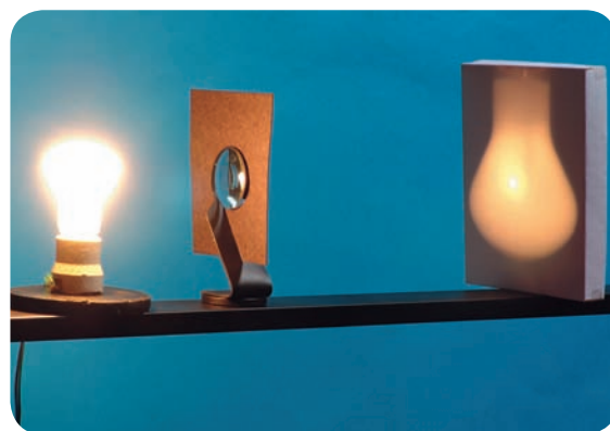
O objeto real está situado entre o ponto antiprincipal objeto C e o foco principal objeto F . A imagem é real, invertida e maior que o objeto.
