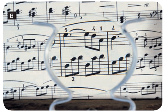
▲ (A) A lente divergente fornece imagem virtual, direita e menor de um objeto real. (B) A lente convergente, funcionando como uma lupa ou lente de aumento, fornece uma imagem virtual, direita e maior de um objeto real colocado entre ela e seu plano focal. Para outras posições do objeto, a imagem é real.
