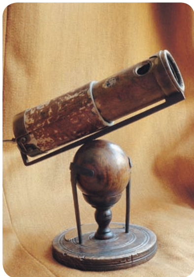
Replica do segundo telescópio de reflexão projetado e construído por Isaac Newton, em 1671.
