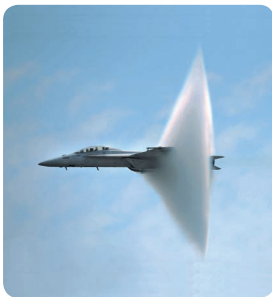
▲ Onda de choque evidenciada pela condensação da umidade do ar, provocada pela quebra da barreira do som por um avião supersônico.
