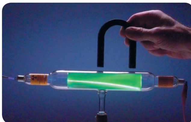
A emissão de elétrons, num tubo de raios catódicos, produz ionização do gás nele contido, com consequente emissão de luz. A presença do ímã desvia a trajetória dos elétrons.
