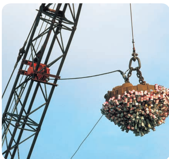
Guindaste eletromagnético sendo usado para levantar sucata metálica.
