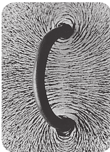
Visualização, com limalha de ferro, de um campo magnético gerado por condutor em forma de espira circular percorrido por corrente elétrica.
