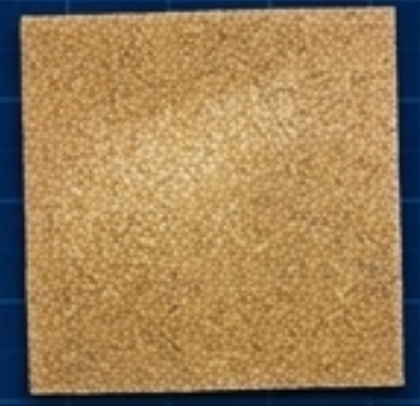
Fio & Lixa: Bobina. Atenção: Usar lixa para remover o esmalte das pontas e garantir contato elétrico.
